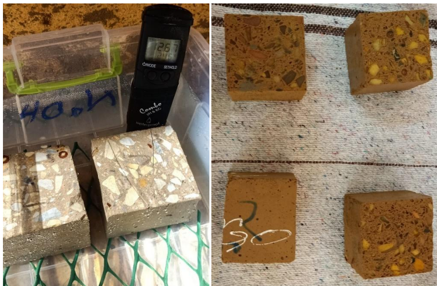
FIGURE 7. Immersion des éprouvettes dans les solutions chimiques.
