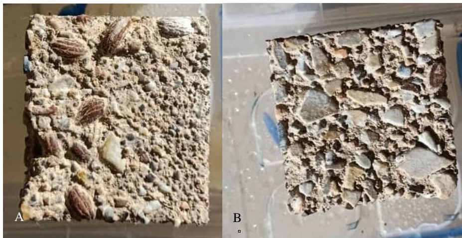
FIGURE 11. Détérioration des échantillons vis-à-vis de l'attaque de l'acide Sulfurique H 2 SO 4 (A- béton auto-plaçant avec grignons d'olives, B- Béton auto-plaçant avec fibres Alfa).
