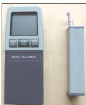
Figure 3. Rugosimètre SurfTest Sj201
