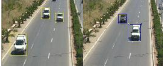
Figure. 5. (a) Localisation des véhicules, (b) Suivi des véhicules par mise en correspondance.
