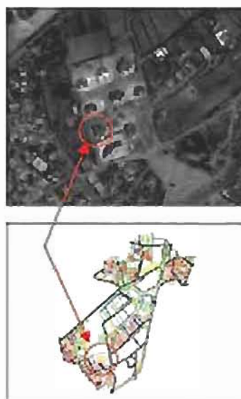
Fig. 3 Exemple de comparaison de donnée satellitaire (scène IKONOS sur la région de Zemouri juste après le séisme 2003) avec la cartographie correspondante existante au 1/25000 de la même région
