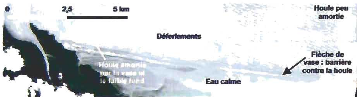
Fig. 11 Propagation de la houle dans la région de Kaw observée sur l'image SPOT du 14/12/2001 (bande XS1), échelle ~ 1:100 000.
