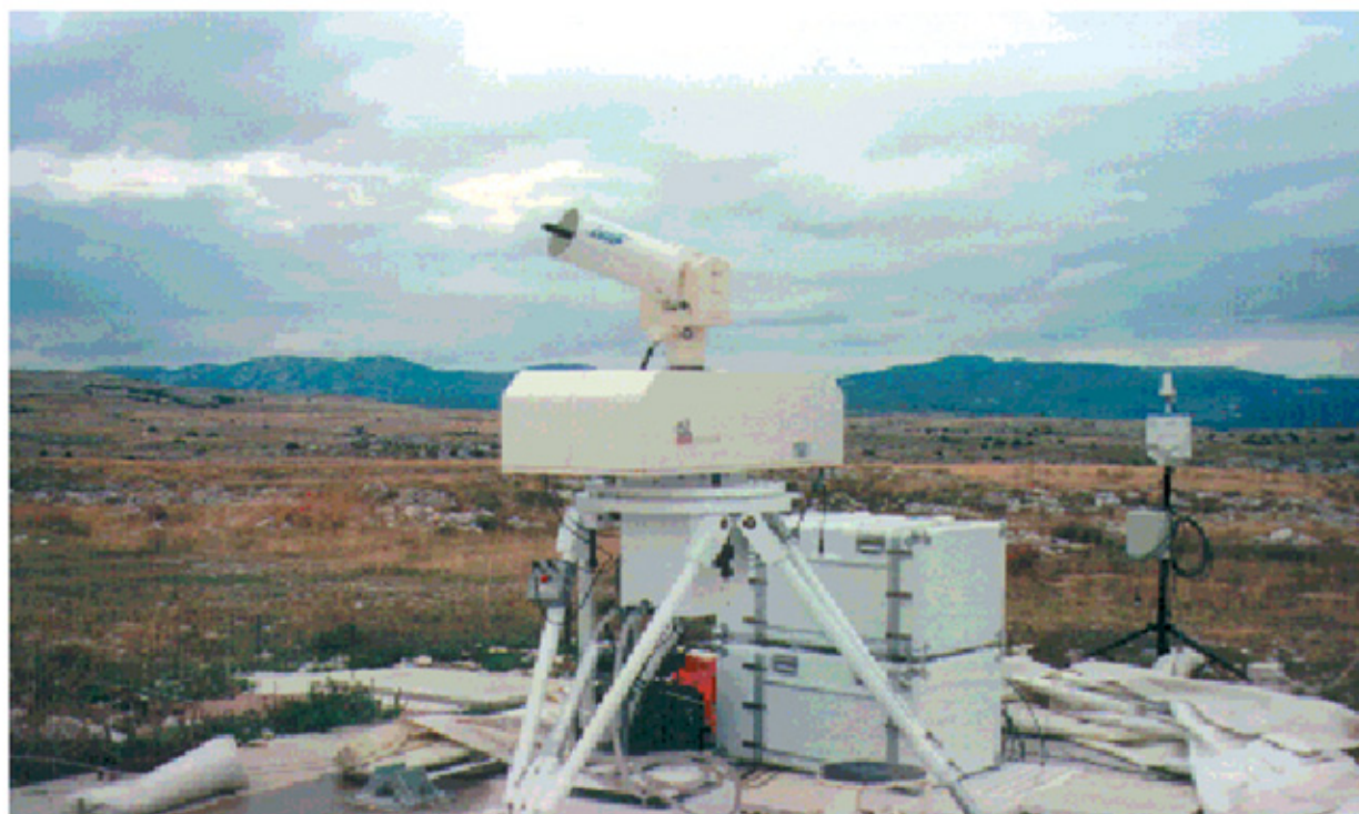
Figure 02 : Une station mobile de télémétrie laser-satellite.
