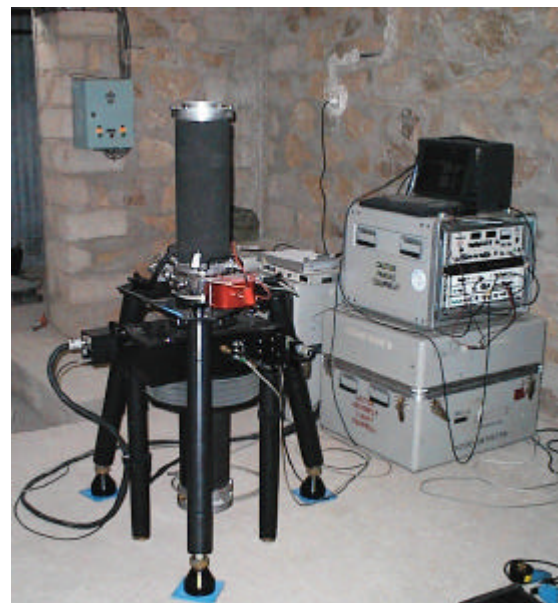
Figure 2. Le gravimètre absolu FG5-111 à la station de Tamanrasset
