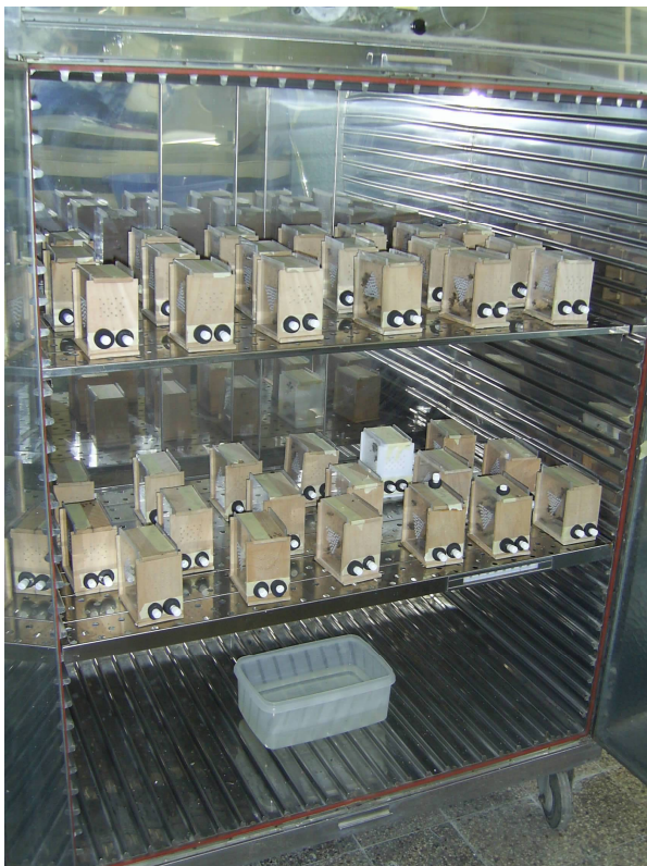
Figure 3.- Cagettes de contenance de type Pain en place dans une étuve lors d'un essai toxicologique (originale)
