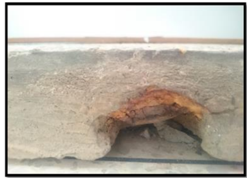
الصورة رقم (12) تمثل ثقب كبير بحامل فسيفساء خلية النحل 2.5. مظاهر التلف البيولوجية 1.2.5. النباتات
