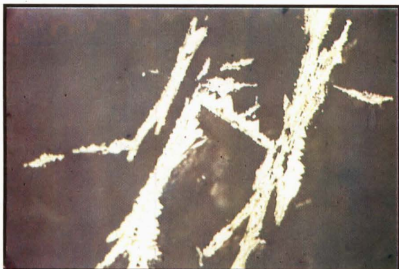
3 - Cristaux automorphes d'arsénopyrite poussant sur d'anciennes aiguilles de stibine (Filon de Koudiet el Ahrach) Automorphic arsenopyrite growing upward acicular old stibine (Koudiet el Ahrach vein)
