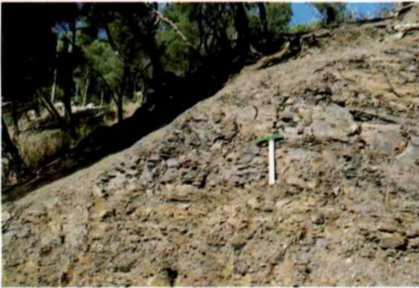
Photo 2 - Marnes crétacées, telliennes, très fracturées et décomprimées (versant du chemin forestier)
