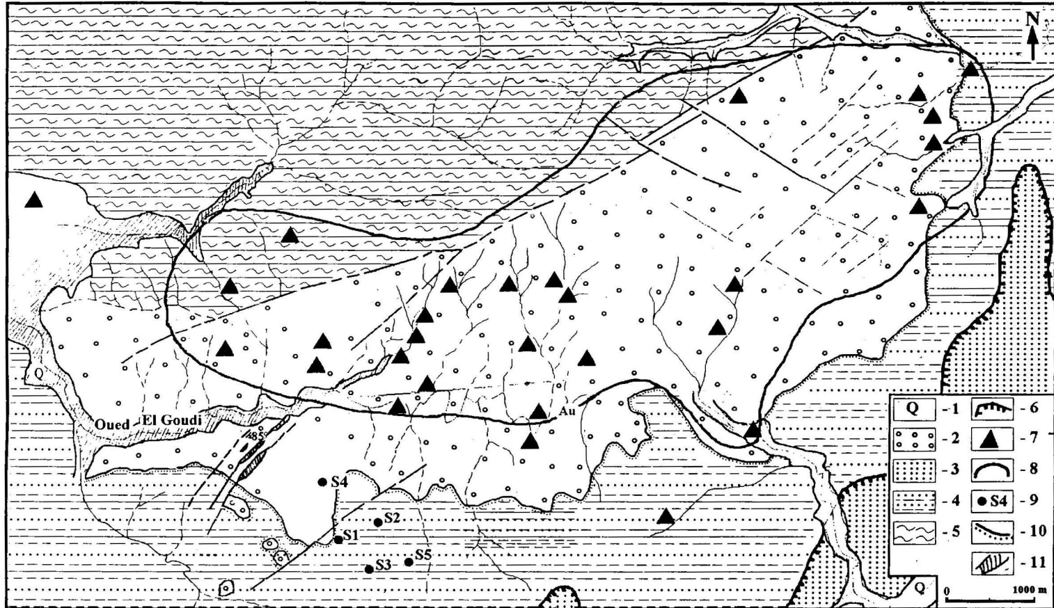
Fig. 2 – Carte de dispersion mécanique de l'or (Auréole de schlich d'or) (EREM, 1989) et localisation de filons polymétalliques
