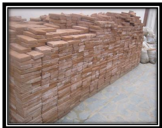
الصورة رقم 04: جانب من الآجر المسترجع في البناء
