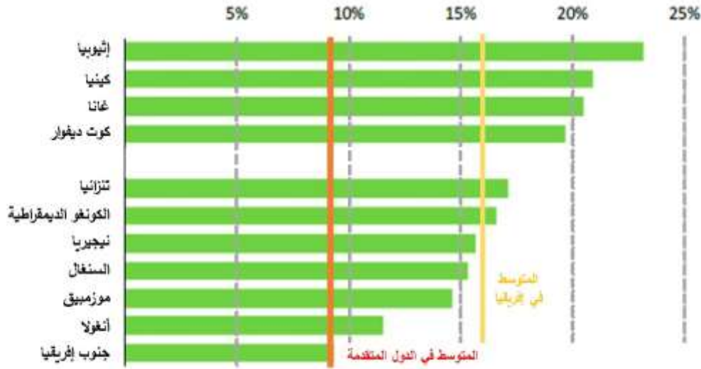
الشكل رقم (03): متوسط خسائر الكهرباء في أنظمة طاقة إفريقية مختارة بمنطقة إفريقيا جنوب الصحراء الكبرى
