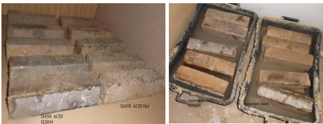
Figure 2. Les éprouvettes des différents types du béton dans milieux agressif.
