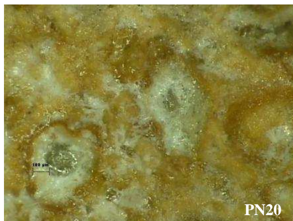
Fig.10. Etat de surface dans la solution de \text{HNO}_3 (X175)
