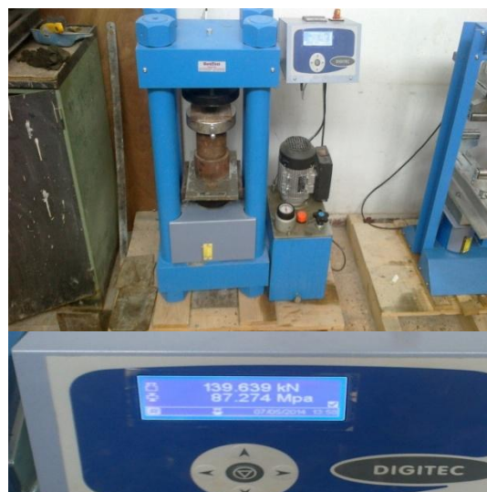
Figure 9: dispositif utilisé en compression
