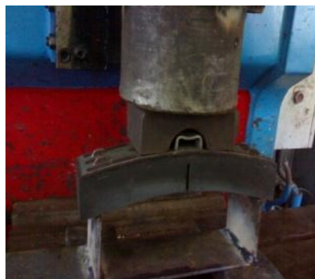
Figure 11 : essai de mesure de la résistance à la flexion de type 1
