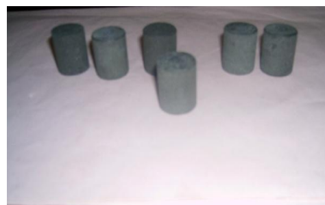
Figure 8 : éprouvettes cylindriques de compression
