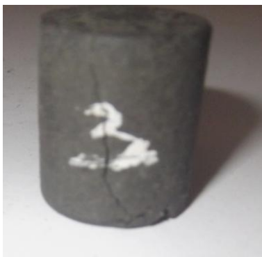
Figure 17 : exemple de rupture du cylindre
