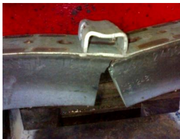
Figure 21 : résultat de l'essai n° 1 de la flexion
