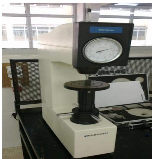
Figure 6 : appareil utilisé pour la mesure classique de la dureté
