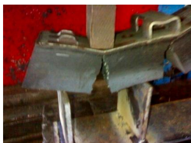
Figure 22 : résultat de l'essai n° 2 de la flexion
