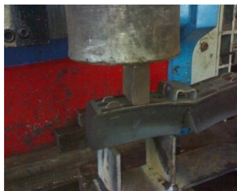
Figure 12 : essai de flexion de type 2
