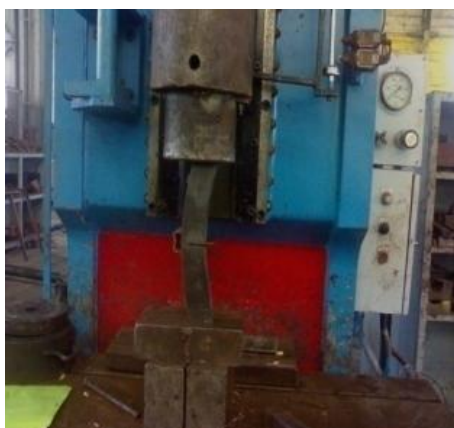
Figure 10: Montage de l'essai de la résistance au cisaillement sur la presse hydraulique
