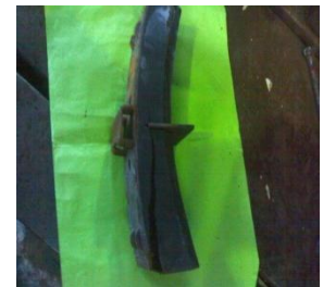
Figure 20 : assemblage (tôle-composite) décollé
