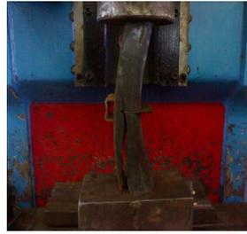
Figure 18 : Résultat des essais de cisaillement
