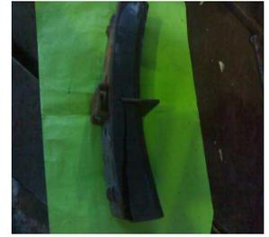
Figure 19: assemblage (tôle-composite) décollé
