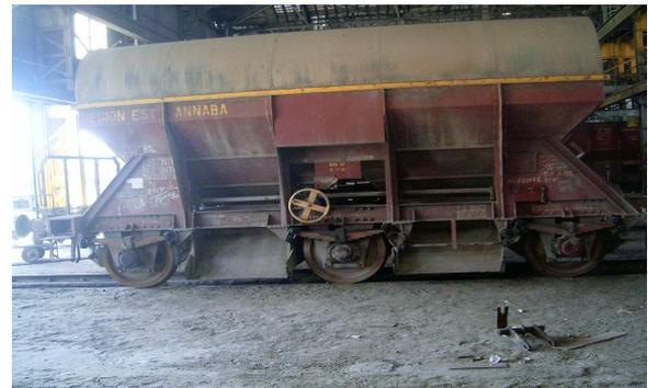
Figure 9 : Exemple d'un wagon à essieux utilisé pour le transport du phosphate et équipé de huit sabots aux roues extrêmes
