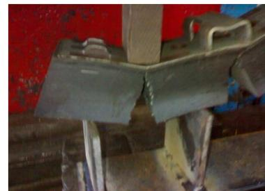
Figure 21 : résultat de l'essai n° 2 de la flexion
