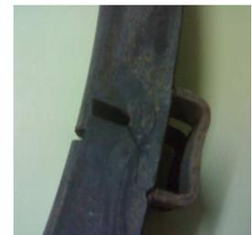
Figure 14 : semelle fissurée à partir de l'entaille
