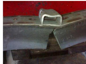
Figure 20: résultat de l'essai n° 1 de la flexion
