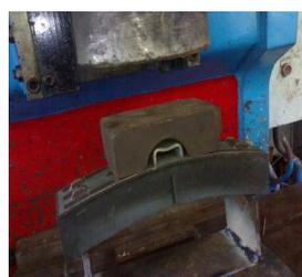
Figure 4: essai de flexion n°1
