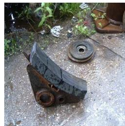
Figure 13 : semelle fissurée
