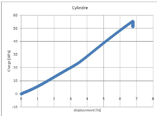
Figure 7 : comportement en compression de l'éprouvette cylindrique
