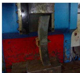
Figure 2: essai de la résistance au cisaillement
