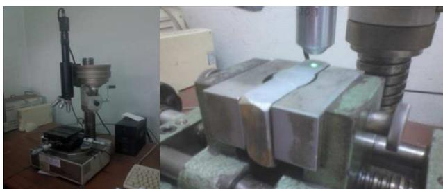
Figure 9 : Procédure et machine de dureté (Type Vickers).
