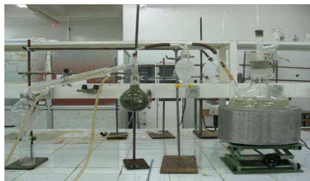
Fig.2: Montage d'entraînement à la vapeur d'eau.
