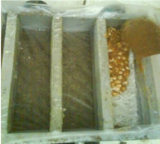
Fig. 4. Tissu dans la zone tendue de l'éprouvette
