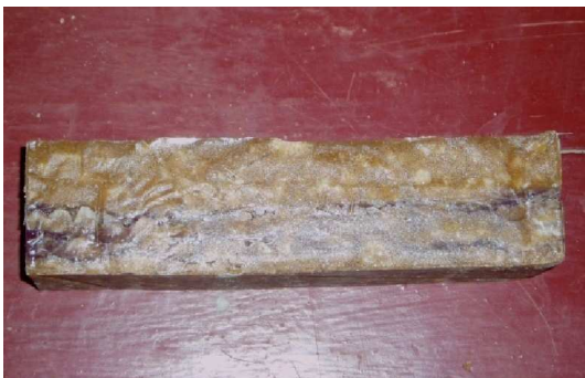
Fig. 6. Couches de tissus dans le béton.
