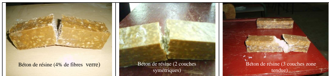
Fig. 12. Mode de rupture des éprouvettes en flexion.
