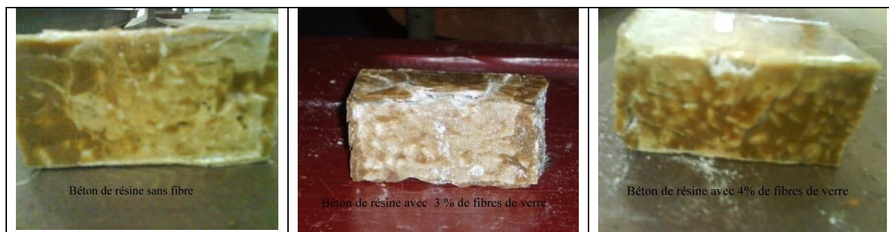
Fig. 13. Mode de rupture des éprouvettes en compression.
