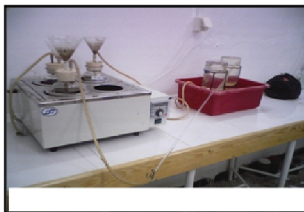
Photo 2. Système de suivi quantitatif du biogaz
