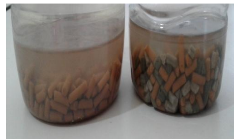
Figure 3 : Déshydratation via les zéolithes.
