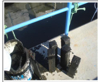
Figure 3. Éprouvettes en béton conservées dans l'eau usée au STEP.
