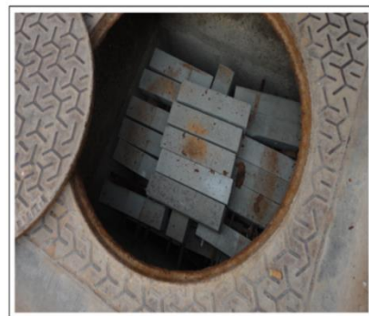
Figure 4. Éprouvettes en béton exposées au gaz carbonique (CO 2 ).
