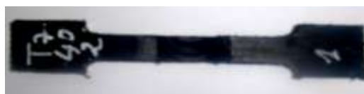
Figure 5 : Éprouvette de traction en PEHD
