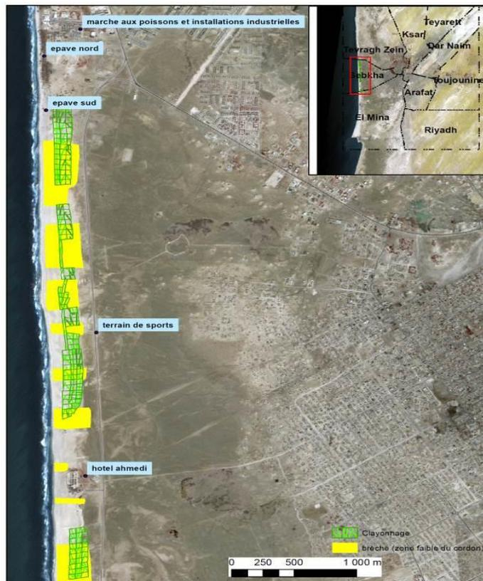
**Figure 3 : Site pilote de la protection du cordon littoral par un système de clayonnage**
