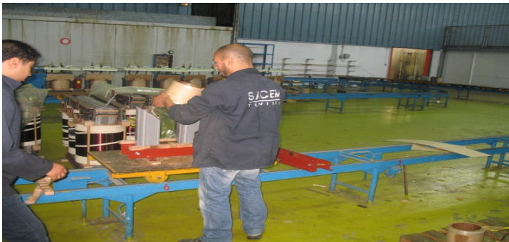
Photo n° 7 : Montage des petites bobines dans les CM Photo n°8 : Montage des grandes bobines dans les CM
