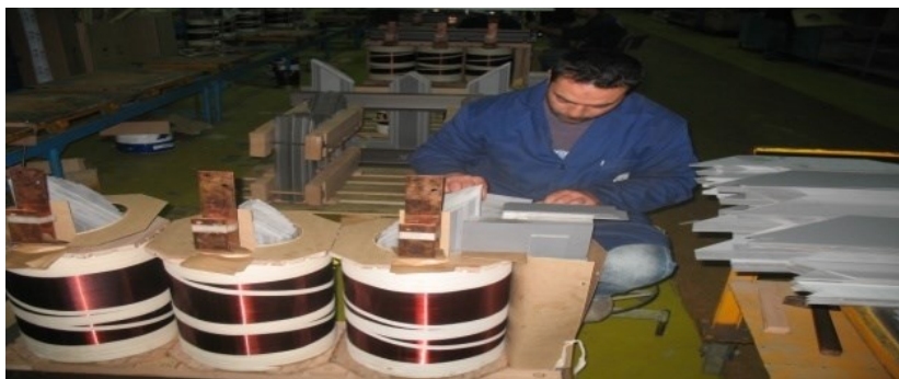
Photo n°9 : Assemblage circuits magnétiques
