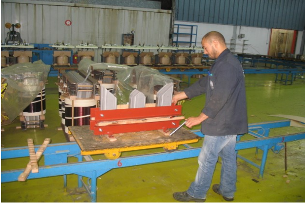
Photo 5 : Mise des CM sur le plan du travail
