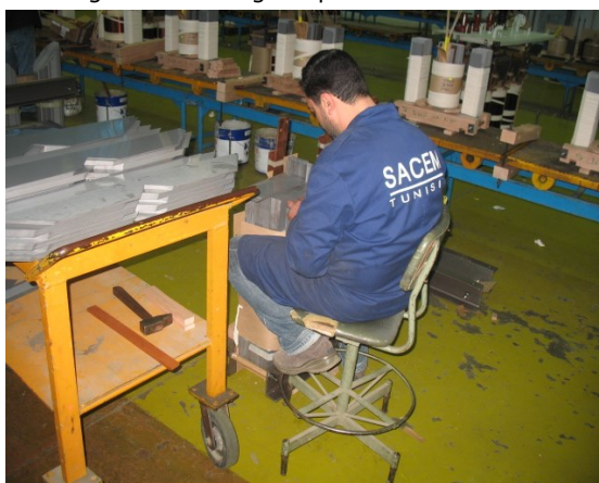
Photo n°9 : Assemblage circuits magnétiques
