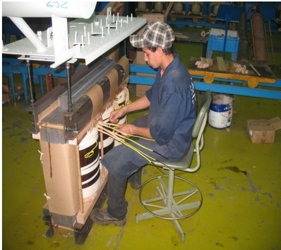
Photo n° 13 : Montage des traversées Moyenne Tension (MT) et câblage MT avec soudure
