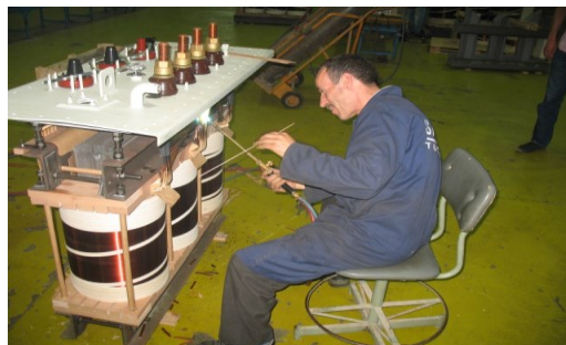
Photo n° 13 : Montage des traversées Moyenne Tension (MT) et câblage MT avec soudure
