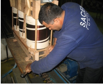
Photo n°14 : Finition de la partie active
