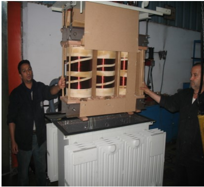
Photo n°16 : Mise En Cuve
