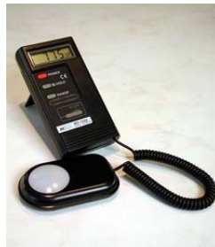
الشكل (2): جهاز اللوكس متر (Luxmètre).
