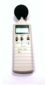
الشكل -2- جهاز قياس الضوضاء.
