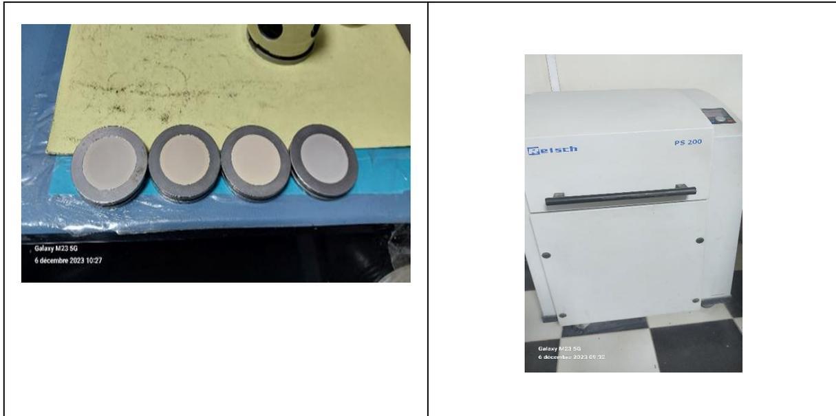
الشكل رقم 02: الأقراص المضغوطة (Pellets)
