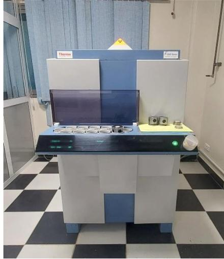
الشكل رقم 05: جهاز تحليل الأشعة السينية (XRF) Thermo Scientific™ ARL™ 9900
