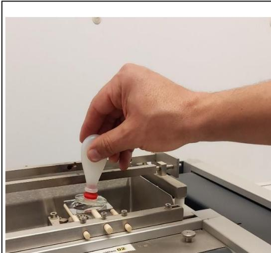
شكل رقم 04: القرص المضغوط (Glasbead)
