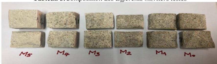
*Figure 1. Etat des échantillons après l'essai de compression*
