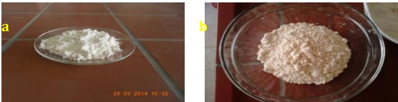
a) Diatomite calciné à  $800\text{ }^{\circ}\text{C}$  b) diatomite calciné à  $1000\text{ }^{\circ}\text{C}$
