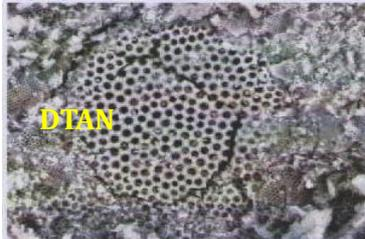
**Fig 6 :** Observation au MEB de la diatomite traitée acide nitrique DTAN.
