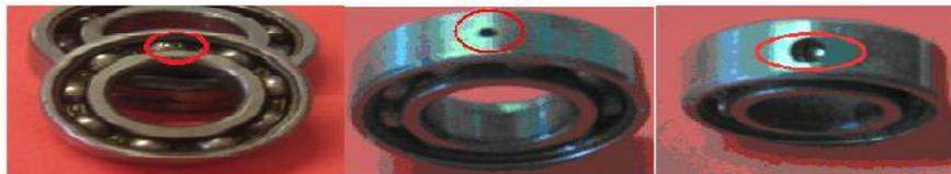
Fig 6: a) Défaut de cage, b) Défaut de bague externe « 3mm », c) Défaut de bague externe « 6mm »
