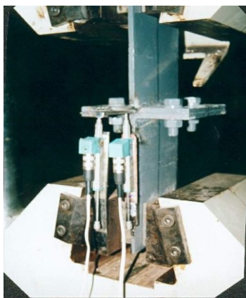
Photo 1 : Positionnement des capteurs de déplacement au droit de l'axe du boulon et au droit de la semelle tendue
