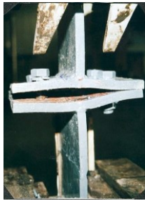
Photo 4 : Rupture du filetage de l'écrou du boulon a empêché la déformation de la platine de continuer- tp=12mm
