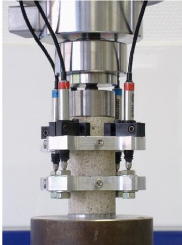
**Figure 2 :** Dispositif expérimental avec 4 LVDT maintenus entre 2 anneaux
