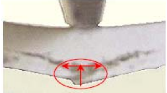
Figure 3 : Mode de rupture par flexion trois points sur éprouvette élancée
