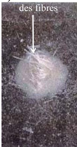
Figure 4 : Différentes phases de propagation du dommage au niveau de la dernière interface résultant d'un impact (énergie impact = 66,29 Joules et la vitesse d'impact = 5,5 m/s)
