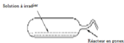
Figure 2 : Réacteur d'irradiation en lumière solaire.
