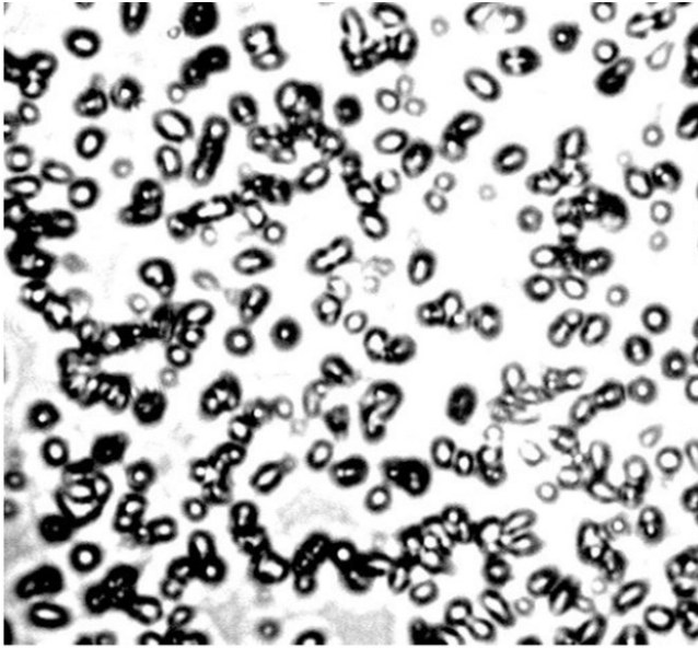
Figure 3 : Traces des particules chargées issues de la réaction nucléaire ^{10}\text{B}(n,\alpha)^7\text{Li} observées dans le détecteur solide de traces nucléaires CR-39.
