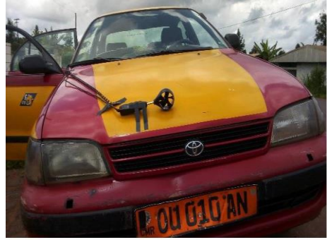
Fig. 1b: Capteur de l'anémomètre monté à l'avant du véhicule
