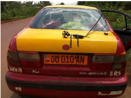
Fig. 1c: Capteur de l'anémomètre monté à l'arrière du véhicule
