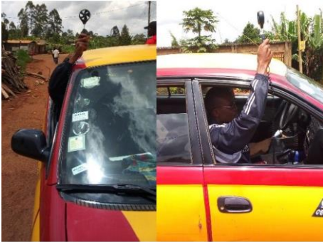
Fig. 1a: Capteur de l'anémomètre Tenu au dessus du véhicule
