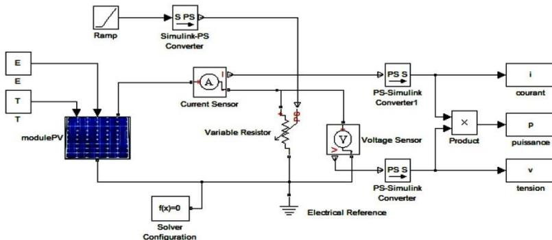
Fig. 1: Simulation du système photovoltaïque sous Matlab
