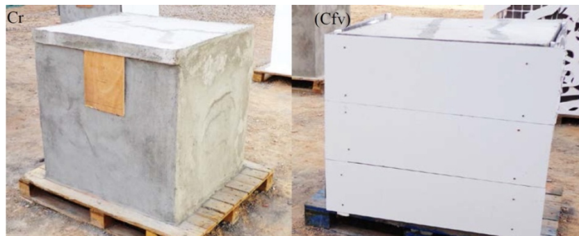
Fig. 5: Les deux cellules tests ( C_r ) 'cellule de référence' et ( C_{fv} ) 'cellule avec façade ventilée'
