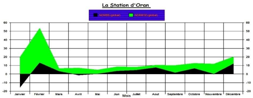
Fig. 27: MBE et RMSE entre les valeurs calculées et mesurées pour chaque mois (rayonnement direct 1986)
