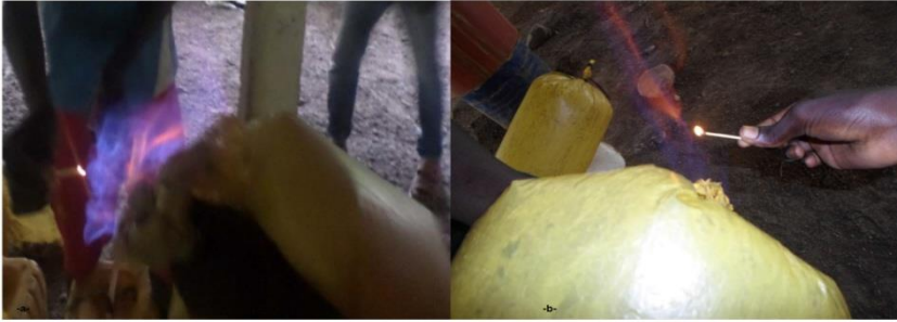
Fig. 8: Test d'inflammabilité du biogaz: (a) période sombre, (b) pendant la journée
