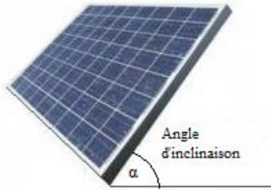
Fig. 3: Angles d'inclinaison des modules photovoltaïques
