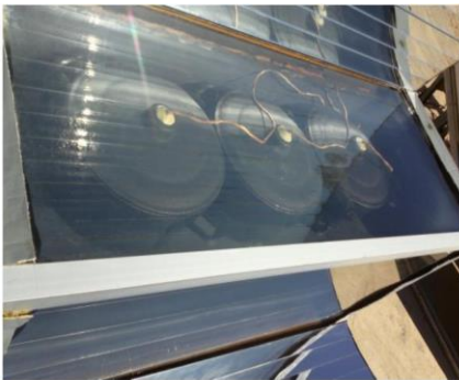
a- Disposition des trois casseroles remplies d'eau et munies de thermocouples
