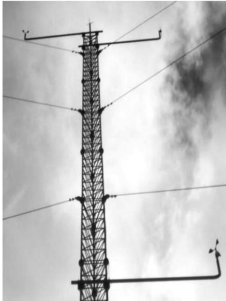
Fig. 2: Pylône d'évaluation du potentiel éolien à Mayotte
