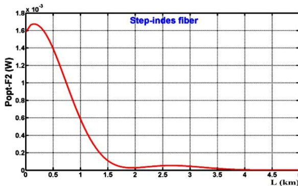
Fig. 9: Variation de la puissance optique en fonction de la longueur d'une fibre optique à saut d'indice
