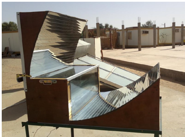
Fig. 2: Vue représentant le prototype du cuiseur solaire de type boîte équipé du CPC sur banc d'essai expérimental à l'URER/MS, Adrar
