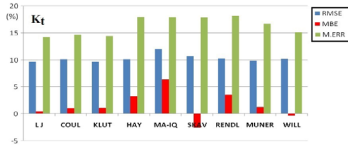
Fig. 5: RMSE, MBE et Erreur Moyenne indiquant les écarts relatifs entre les valeurs expérimentales estimées pour les différents modèles en tenant compte de K_t seul
