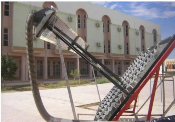
Fig. 1: Concentrateur solaire Fresnel avec jeu de miroir à réflexion linéaire
