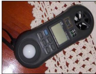
Fig. 9: Instrument de mesure, modèle LM – 8000 utilisé
